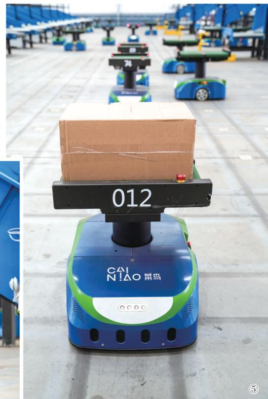
1月22日，由阿里巴巴旗下物流平台菜鸟网络开发的物联网机器人分拨中心在南京正式启用。本次启用的物联网机器人分拨中心面积约为2000平方米，共有100台物联网分拨机器人，主要用于中大件包裹分拨，机器人分拨系统可以处理超过九成商超类包裹，预计比传统人力分拨效率提升1.6倍。
